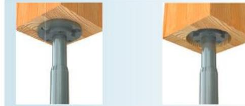
Die Kopfplatte des Power Base F entspricht grundsätzlich jener der C-Typen. Die Unterschiede liegen in der Scheibenstärke, die lediglich 10 anstatt 12 mm beträgt und in der Verschlussart an den Unterbau. Hier kommt ein zusätzlicher Flanschring zum Einsatz, der an die Kopfplatte mittels drei Inbusschrauben befestigt wird. Ein Zerlegen ist für das Aufschrauben an eine Säule nicht zwingend notwendig aber optional möglich.
