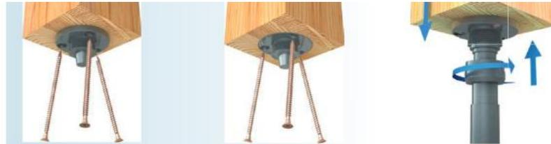
Die Kopfplatte soll stirnseitig zentriert und mit drei SHERPA Spezialschrauben 8 x 160 mm oder 8 x 180 mm in einem Winkel von ca. 25° befestigt werden. Mit dem Konus wird die Kopfplatte (t=12 mm / Ø 96 mm bzw. Ø 106 mm) passgenau auf den Unterbau gesetzt. Die Verbindung der beiden Teile erfolgt mit der Überwurfmutter als Schraubverschluss (Gabelschlüsselweite 55 mm).
