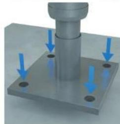
Die Sockelplatte wird wahlweise mit vier Metallspreizdübeln oder Betonschrauben verankert. Fertigungstoleranzen und Setzungen im Gebäude können auch noch unter Last ausgeglichen werden (Gabelschlüsselweite: Power Base C...32 mm
